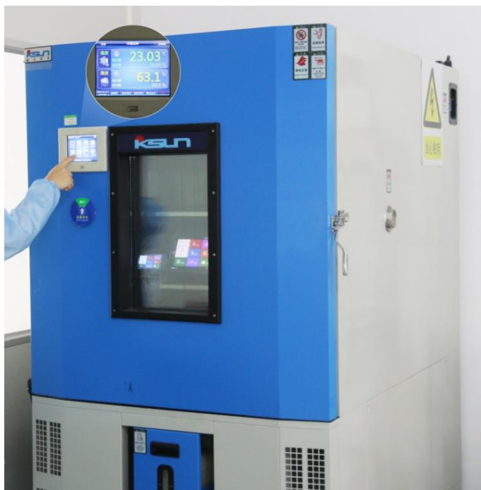
图 5-3 高低温老化测试图
